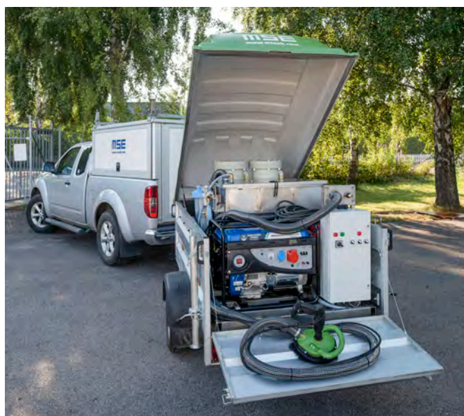
HULLWASHER levereras på släp för mobilitet
